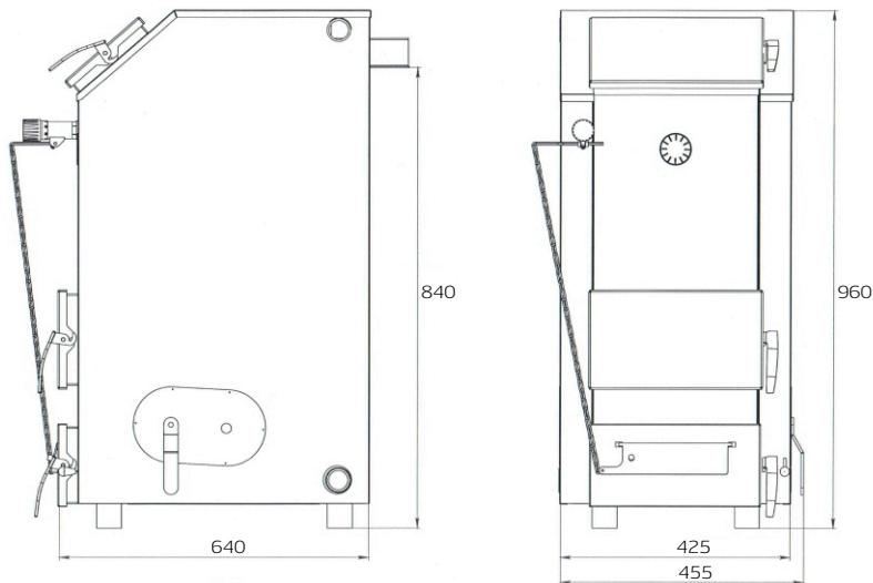
Рис.5 Габаритные размеры котла «МАГНУМ» КДГ 20ТЭ.
